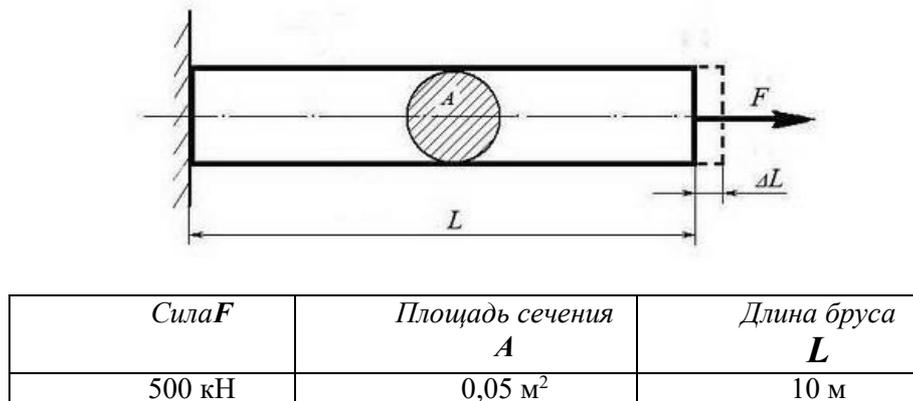
(Ответ: удлинение бруса  $\Delta L = FL / (EA) = 5 \times 10^5 \times 10 / 2 \times 10^{11} \times 0,05 = 5 \times 10^{-4}$  м или  $\Delta L = 0,5$  мм)
