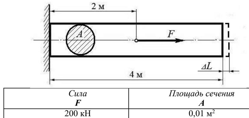
(Ответ: общее удлинение бруса  $\Delta L = FL / (EA) = 2 \times 10^5 \times 2 / 0,4 \times 10^{11} \times 0,01 = 10^{-3}$  м или  $\Delta L = 1,0$  мм)
