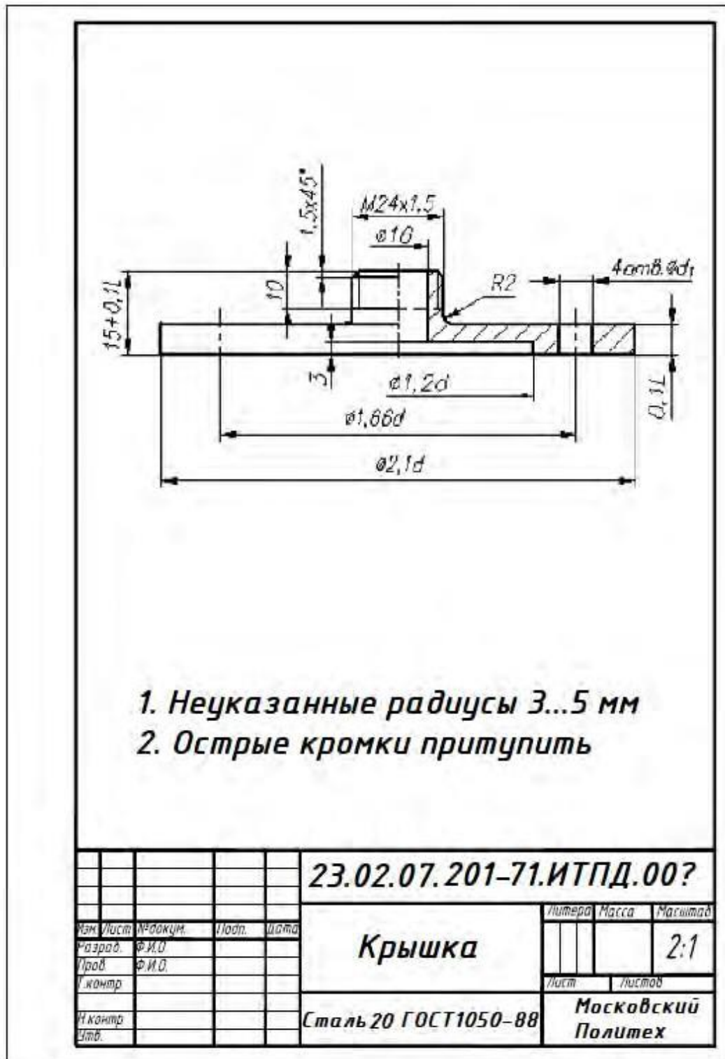
Рисунок 10. Пример выполнения чертежа детали «Крышка»
